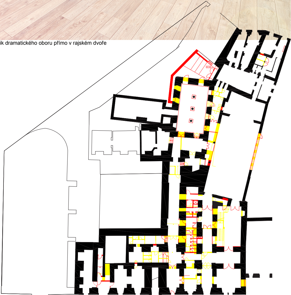
přodory bouraných a nových konstrukcí
